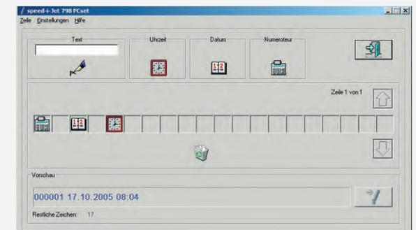
Die Software für den *speed-i-Jet 798* erklärt sich von selbst: Text eingeben, Datum, Uhrzeit und fortlaufende Nummer definieren und per USB übertragen!
