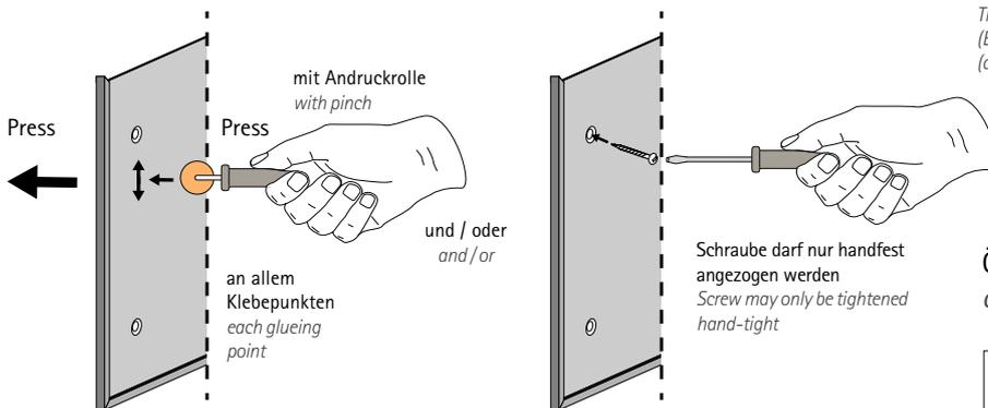
Montagekleber benötigen ca. 24h bei Raumtemperatur (20°C) zum Aushärten!
