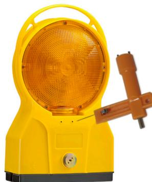
5. Mit der herauschiebbaren Spitze am Lampenschlüssel wird die innenliegende Elektronik über die Öffnungen im Gehäuse bedient. links E/A = Ein/Aus rechts B/D = Blinklicht/Dauerlicht
