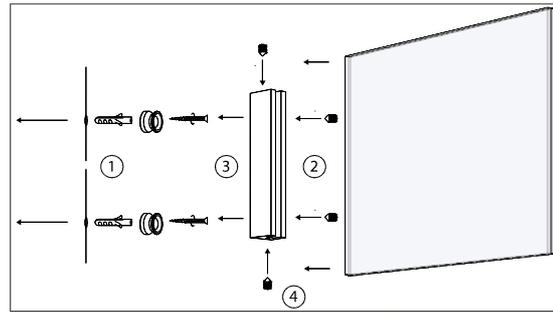
Das Fahnen Schild besteht aus zwei ESG-Scheiben und einem Fahnenadapter.
