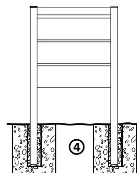
Aufsteller kann im komplett montierten Zustand nicht mehr entfernt werden. Bei einer Aufstellung mit Splitt ist ein Ziehen und Umsetzen der Schildposten möglich.
