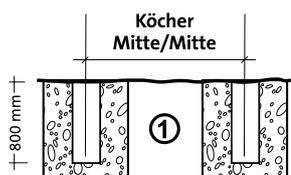
Fertiggestelltes, abgebundenes Köcherfundament aus Beton C20/25. Sie können den Aufsteller auch mit Standfüßen auf ein bereits vorhandenes, ausreichend dimensioniertes Fundament ausübeln.
